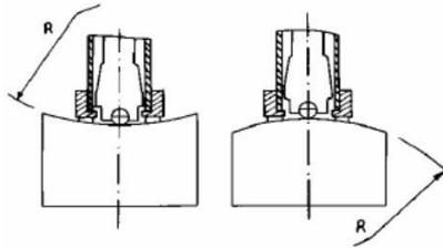
为方便各种异型曲面的测试，对 D、DC、D+15、C、E 型冲击装置，也可另外购买我公司的异型支承环，以获得最佳测试条件。具体请参照下页表 4 选用
