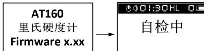
自检过程中仪器会自动识别冲击装置类型，最后进入测量主显示界面：
